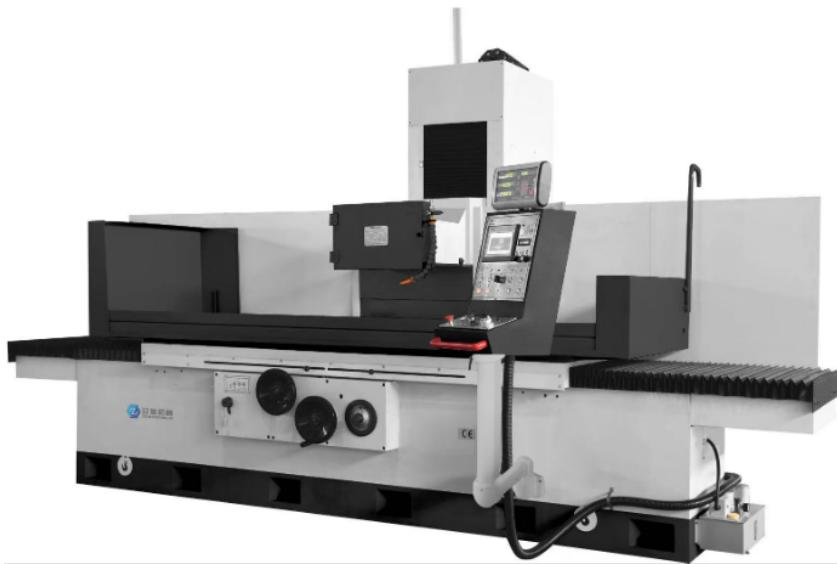
平面磨床的操作方法是什么样的？启动润滑油泵、液压泵电机，检查调整液压系统压力，润滑系统压力，并用手转动砂轮轴，检查转动是否轻快；点动磨头横向进给，检查砂轮与金刚笔、工件的相对位置；将工作台往复运动15-20分钟，排出油缸中空气，以消除爬行，然后调整行程和速度。工作时，要根据工件大小调整进给位置，及工作台上各撞块。装卡工件必须牢固，合理选用磨削量，测量工件时应把砂轮退离停车。定期检查工件轴皮带的松紧程度，及时调整。经常检查砂轮是否有裂纹，严禁改装用做端面磨削。更换新砂轮必须检查是否有裂纹，经过平衡装上修整后再第二次平衡试车正常后方可使用。禁止在无防护罩的情况下进行加工，禁止在或工作台面敲打工件。南通动柱式平面磨床价钱自动平面磨床定位基准可靠。
