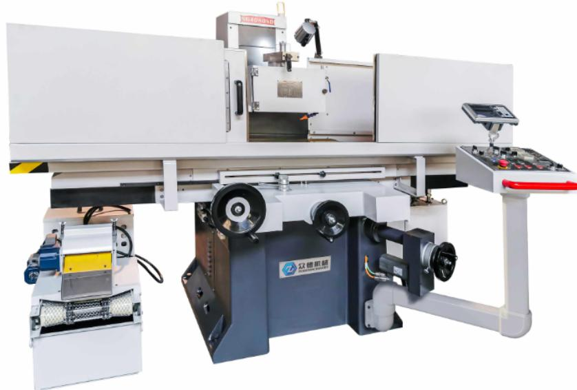
平面磨床在维修要注意的事情：平面磨床在维修时要考虑多种变形的影响，床身与滑鞍座两组导轨修理中，应保证其垂直度。装配时还要注意工作台纵向运动的油缸与齿条、横向进给的丝杠螺母与油缸的关系以及它们之间的垂直度要求。为保证、纵横导轨的垂直度及保持横向进给机械的尺寸链精度，选择横向进给滑鞍座的油缸孔为修理基准，首先修复滑鞍座两根导轨。可用铸铁平板拖研检查滑鞍座底面（固定结合面），螺孔周围接触良好即可。为考虑变形的影响，刮研前床身应按试车安装要求，用调整垫铁调整好安装水平。为避免刮完导轨后装上其它部件引起变形，在刮研床身前应将滑鞍座刮好固定，并将砂轮箱，液压操纵箱，手摇机构等预先装上，再刮研以上身导轨达到要求。
